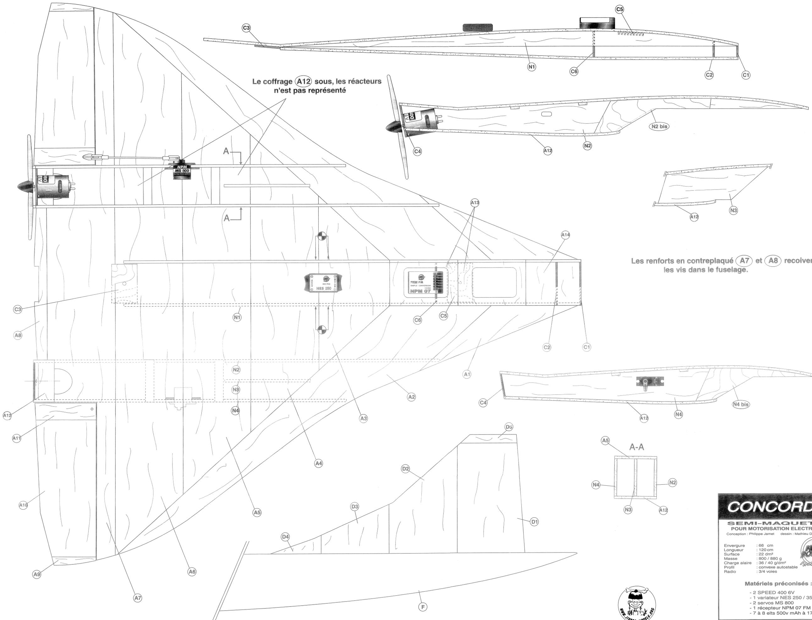
Les renforts en contreplaqué (A7) et (A8) reçoivent les vis dans le fuselage.
