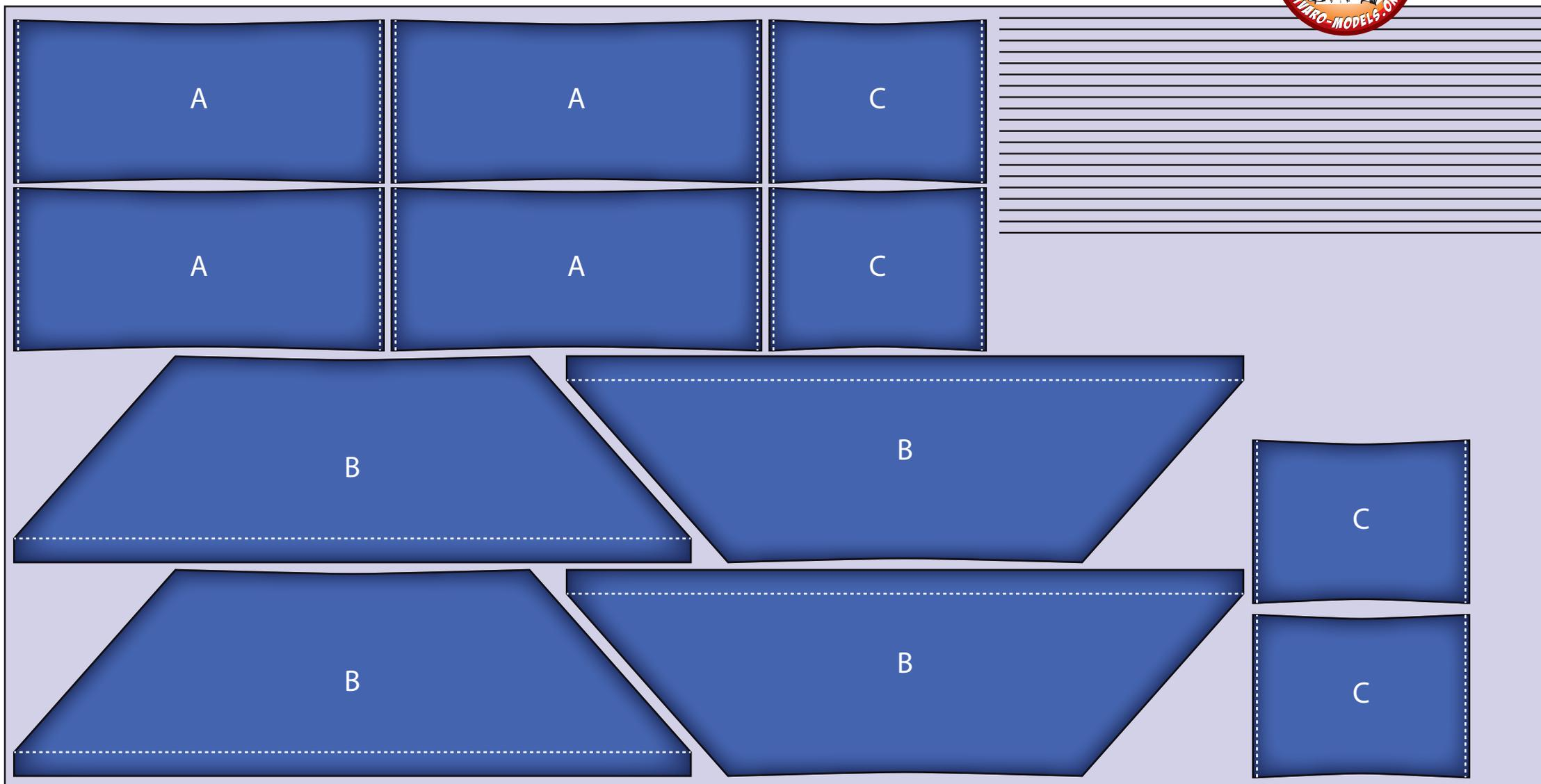
Positionnement, sur du spi de largeur 1 m et longueur 2 m, des différents éléments constituant le Cloud Seeker (panneaux plus ourlets rapportés)
